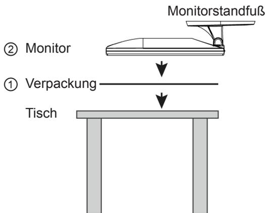
1. Platzieren Sie den Bildschirm mit der Anzeige nach unten auf der Verpackung.
