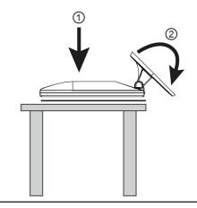
2. Appuyez sur et tenez le moniteur avec la main gauche et faites tourner la base de moniteur par 90 degrés vers la bas avec la main droite.
