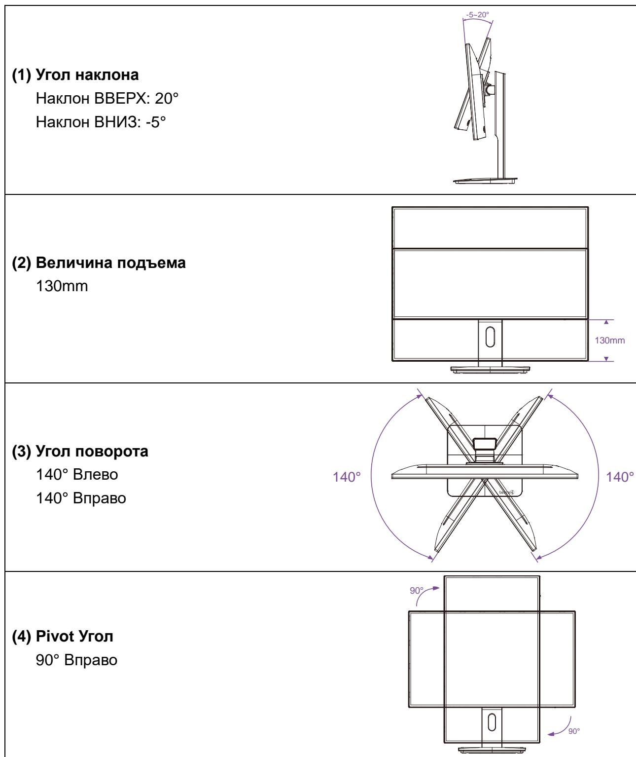
**Примечание:** чтобы не поцарапать стойку, наклоните экран назад, поверните его и верните в прежнее положение.
