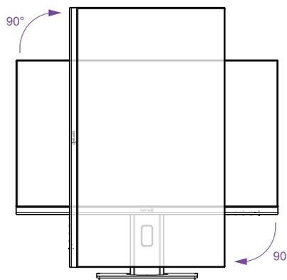
**Примечание:** чтобы не поцарапать стойку, наклоните экран назад, поверните его и верните в прежнее положение.
